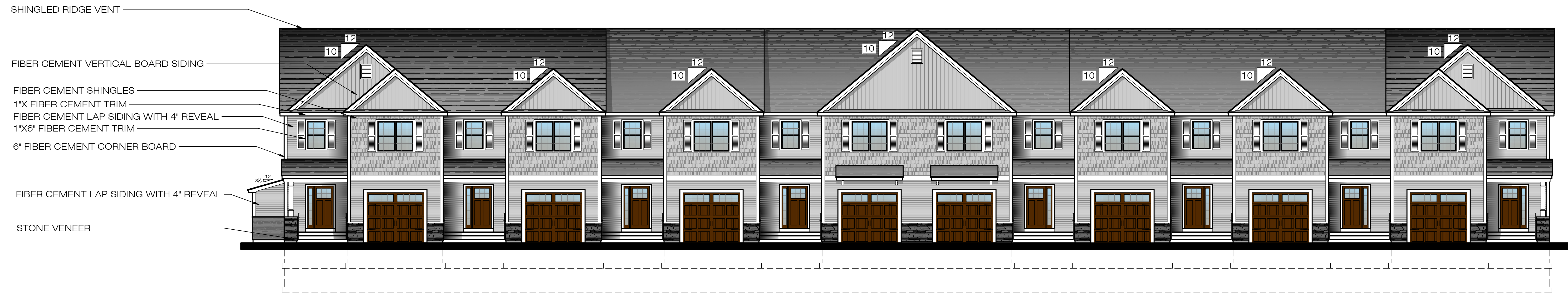
1 FRONT ELEVATION SCALE: 1/8" = 1'-0"
